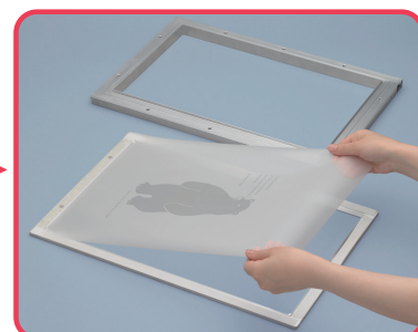
③ 枠張りして完成
