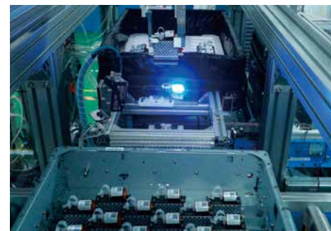
インクジェット印字ヘッドユニットの組み立て治具を内製
