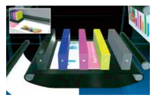
並列に配置されたライン型インクジェット印字ヘッド
