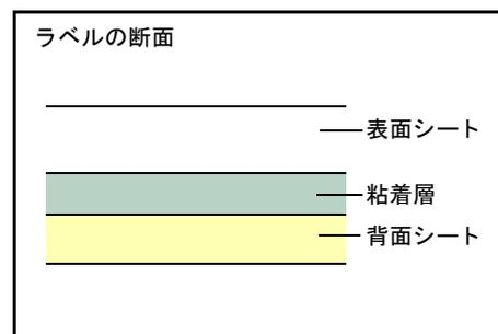
ラベル紙の表面は、表面シートで隙間なく完全に覆われていなくてはなりません。ラベルの間に隙間のあるものはラベルがはがれやすく、大きな故障の原因となります。
