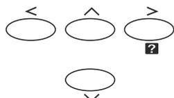
目的のメニューを表示させるときや、設定値の変更を行うときに使用します。[∧] [V] キーでメニューを切り換えて、[<] [>] キーでサブメニューに移ります。また、紙詰まりなどが発生したときに [?] キーを押すと、メッセージディスプレイにオンラインヘルプメッセージを表示します。オンラインヘルプを中止するときは、もう一度押します。
