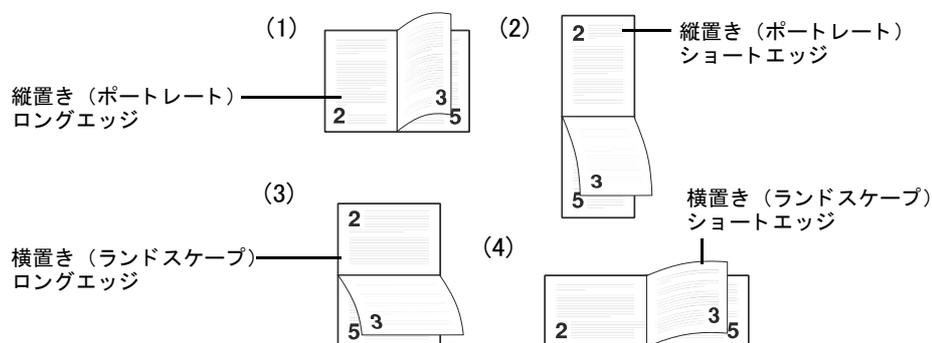
次の手順で、製本モード（両面印刷モード）を選択してください。この手順はオプションの両面ユニット DU-61 が装着されている場合のみ設定できます。
