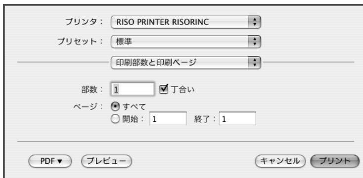
プリントする原稿データの印刷部数と印刷ページを指定します。丁合いのチェックは外してください。詳細なプリント条件を設定する場合は[リストボックス]から各設定項目を表示させ、設定を行います。( P.13)
